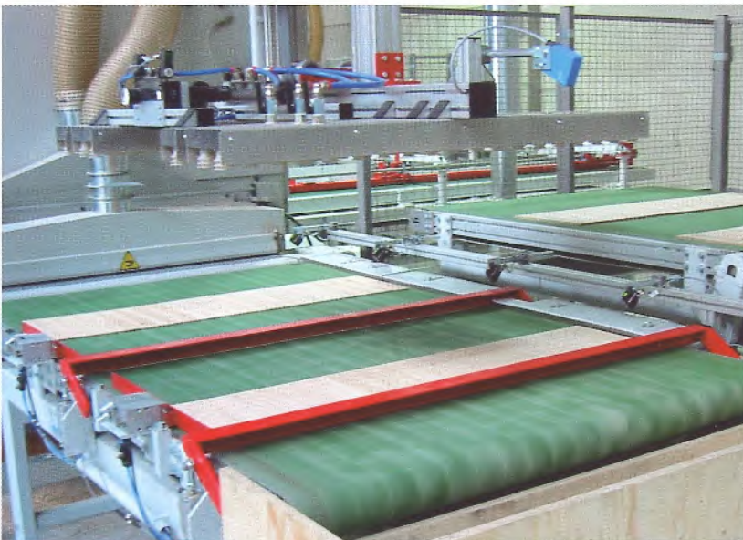
Auslaufsituation hinter der Schleifmaschine Outfeed after sanding
