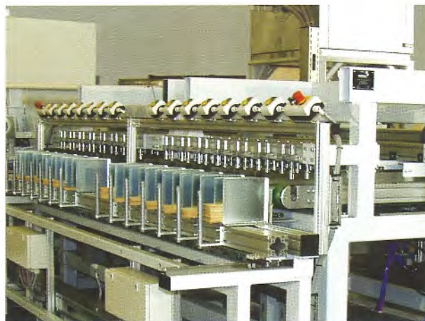
Automatische Stapelbildung mit manueller Entnahme der Lamellenpakete Automatic stack-building with manual unloading of lamella packages
