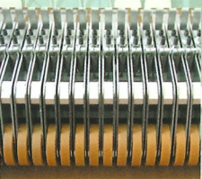
CPS II Elektronik-Schleifschuh mit feingliedriger Abtastung und Segmentierung
