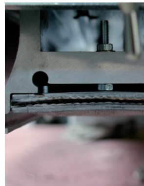
pneumatisch abgestützter Druckbalken
