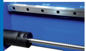
Linearführung und Kugelrollspindel von Bosch, BZT PFG-S Linear guiding and ball screw spindles Bosch, BZT PFG-S
