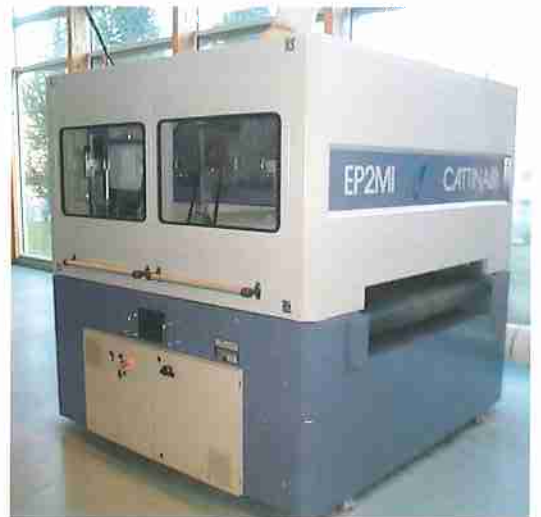
■ Machine EP2MI EP2MI denibbing machine
