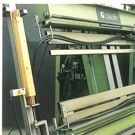
Particolare dispositivo di posizionamento verticale fotoelettrico.
