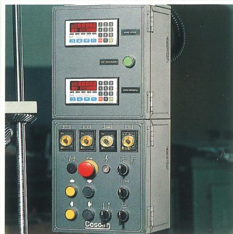
Quadro elettrico: posizionamento numerico con memorie a 2 assi.
