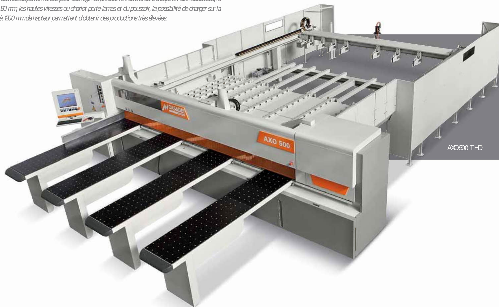
Heavy duty H pusher structure height 130 mm Robuste structure arrière sur poutres en profil "H" - hauteur 130 mm
