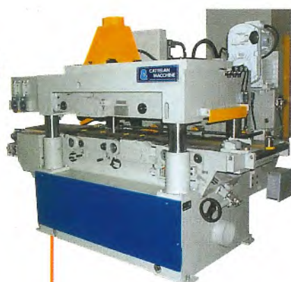
PIALLATRICE A 3 ALBERI FILO SPESSORE MULTILAME 3-SPINDLE PLANER TOP BOTTOM MULTIBLADE
