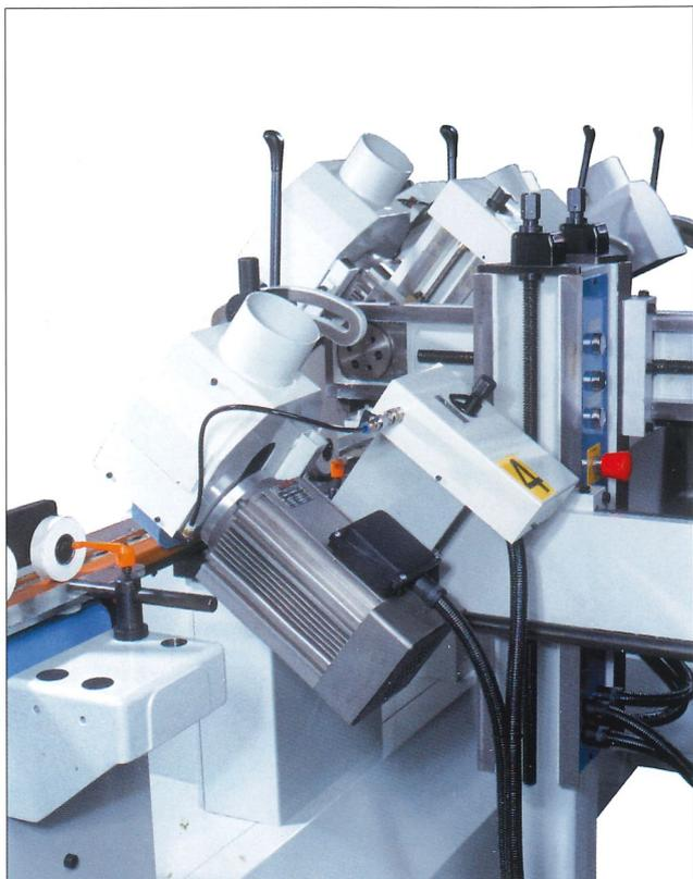
Gruppo levigatore a mola abrasiva con sistema di recupero automatico. E' possibile dotarlo di entrata a tempo per alimentazione a pezzi singoli.
