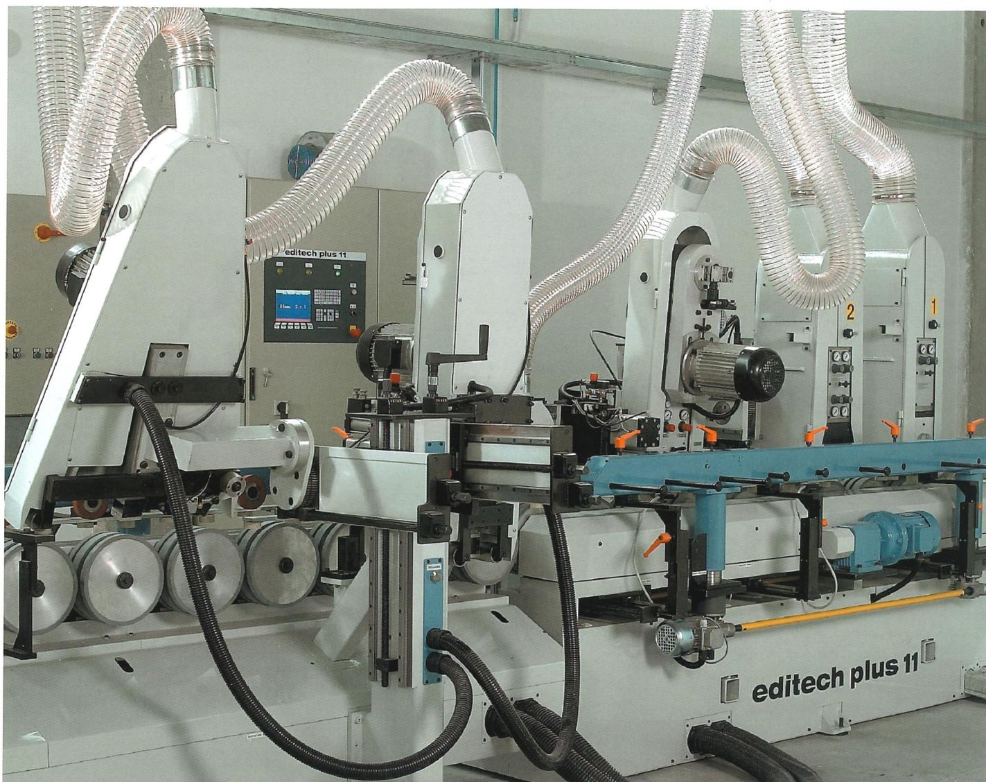
Il sistema di avanzamento a ruote fa di questa levigatrice la soluzione ideale per la lavorazione dei profili ad angolo (stipiti di porte, ecc). Aggregati di levigatura a mole (con recupero d'usura) o a nastro danno flessibilità alle operazioni di levigatura.
