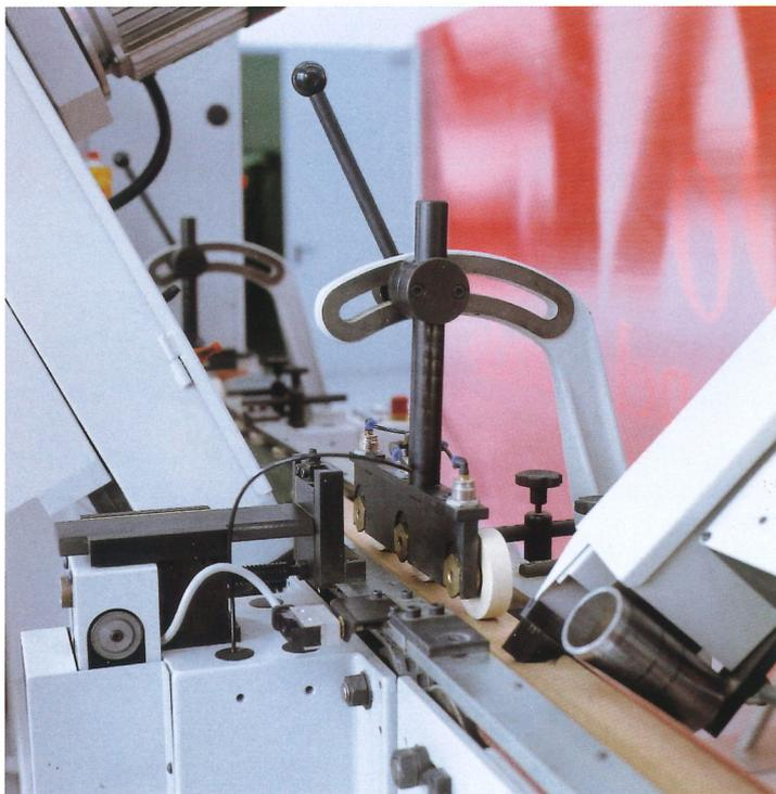
Le guide pezzo, con traslazione motorizzata, permettono un rapido attrezzaggio macchina.
