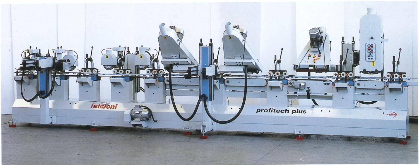
Empfohlene Lösung für das Schleifen jeden Leistentyps. Die Maschine kann mit Schleifscheibenaggregaten mit automatischer Abnutzungsanpassung ausgestattet werden, mit Schleifbändern für flache oder geformte Oberflächen oder mit speziellen Schleifaggregaten.
