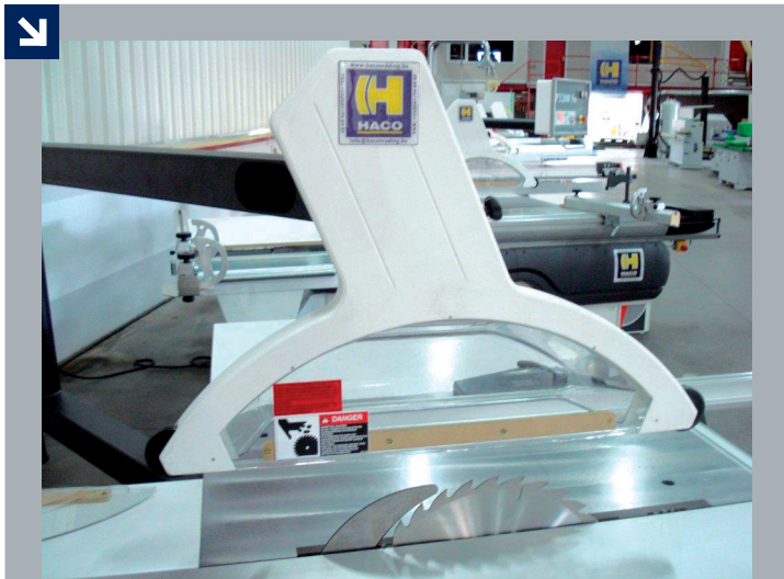
Protection scie et aspiration conforme aux normes CE Zaagbescherming en afzuiging conform CE norm
