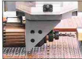
● NC-gesteuerte horizontale Elektrospindel
