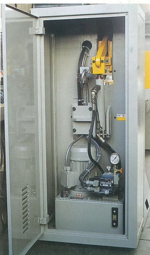
In der Mod. TM 3100 ist der Betrieb des Messers und des Niederhalters elektromechanisch (rechtwinkligachsinger getriebe höher Leistung erlaubt die Verwendung eines elektrischen Motors Kleiner Leistung). In der Mod. TO 3100 ist der Betrieb des Messers und des Niederhalters hydraulisch (Hydraulisches Steuergehäuse lt. 25).
