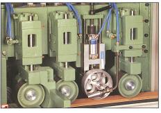
Vorschub nur von oben angetrieben! Das garantiert sicheren Transport selbst von verwundenen Brettern.
