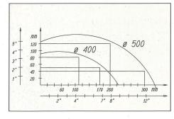
Das Schnittdiagramm für große Holzquerschnitte. Breite bis 300 mm, Dicke bis 120 mm, max. Querschnitte 300 x 40 oder 200 x 120 mm. Bei Sägedurchmesser 500 mm.
