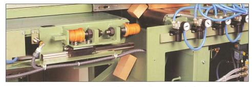
In der OptiCut ist unmittelbar an der Säge ein automatischer Trennschacht integriert. Abfall und Gutstücke werden so 100%ig sicher getrennt. Kein Abfallstück kann sich unter die Gutstücke einschmuggeln. Dimter-Patent!
