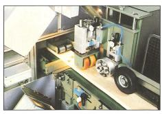
Optische Fehlererkennung und -Definierung mittels Zeilenkamera. Der Dimter-Scanner "DiScan" statt Markierer. Bei vielfältigen Qualitätskriterien und hoher Leistung.
