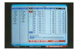
Alles auf einen Blick: Schnittliste mit Werten und Stückzahlen, Holzalitäten je Holzquerschnitt, Länge und Wert der Keilzinken-Teile, Maßliste und Schnittliste jedes bearbeiteten Brettes.
