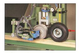
Selbst bei Schlupf zwischen Holz und Vorschub kommt es nicht zu einer Längenungenauigkeit. Denn die Längenmessung erfolgt durch ein unabhängiges, schlupffreies Meßrad. Präzision unter allen Umständen!
