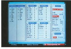
PC-gesteuerte Darstellung der Status-quo-Situation der Linie. Dadurch einfachste Fehlerdiagnose und Überwachung.
