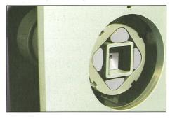
Der Sägesupport ist für Auf-Ab-Bewegungen mit einem Torsionsdämpfer ausgestattet. Die OptiCut arbeitet dadurch leise, schnell und verschleißarm. Dimter-Patent!
