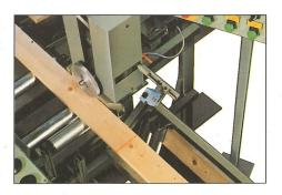
Neben der Kreidemarkierung von Hand bietet Dimter die anspruchsvollere Lasermarkierung. Präzise Positionierung der Markierung. Platzersparnis bis zu einer maximalen Eingangslänge.
