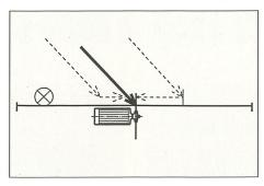
Die Schnittposition wird ständig elektronisch überwacht und wenn nötig korrigiert. Das vermeidet eine Aufaddierung von Schnittfehlern zum Brettende.
