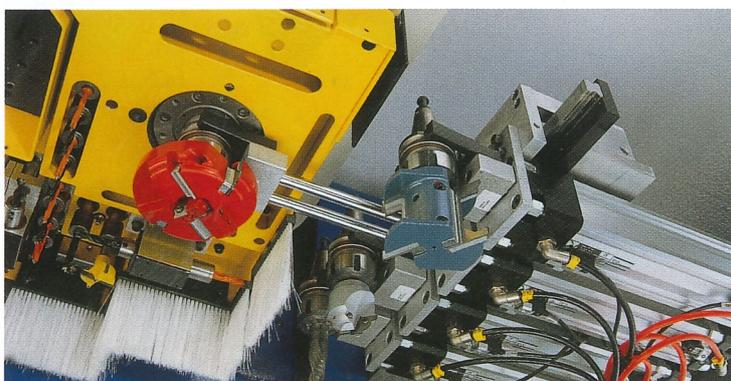
Werkzeugwechsler ohne Gehäuse
