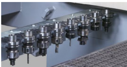
2 8-fach Linearwechsler seitlich am Maschinenständer.
