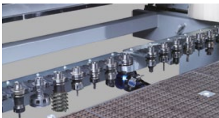
1 8-fach Linearwechsler seitlich am Maschinenständer.
