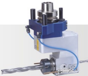
HSK F63 Schlosskastenaggregat mit 1 Ausgang ER 32 für Bohr- oder Fräswerkzeug mit zwei Druckluftausblasdüsen und 1 Ausgang hinten ER 16 für Bohr- oder Fräswerkzeug Best.-Nr. 300-24-017 Best.-Nr. 300-24-038 (H08 2I-3IP)
