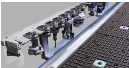
4 10-fach Linearwechsler hinten am Maschinenständer.
