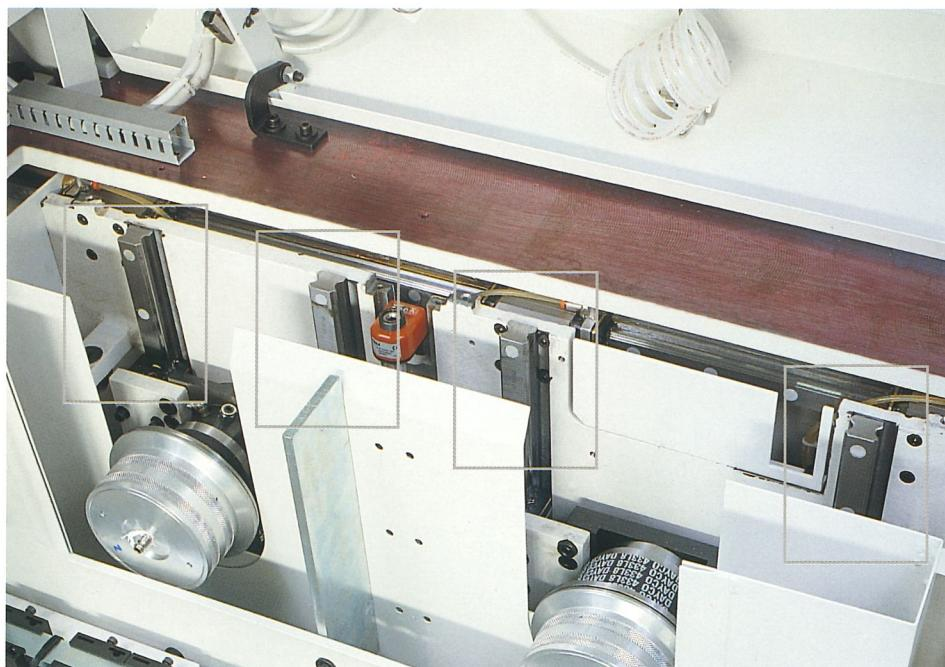
La salita delle lame avviene su guide prismatiche a ricirculo di sfere che assicurano una perfetta perpendicolarità col piano di lavoro con il risultato di un'eccellente finitura di taglio.
