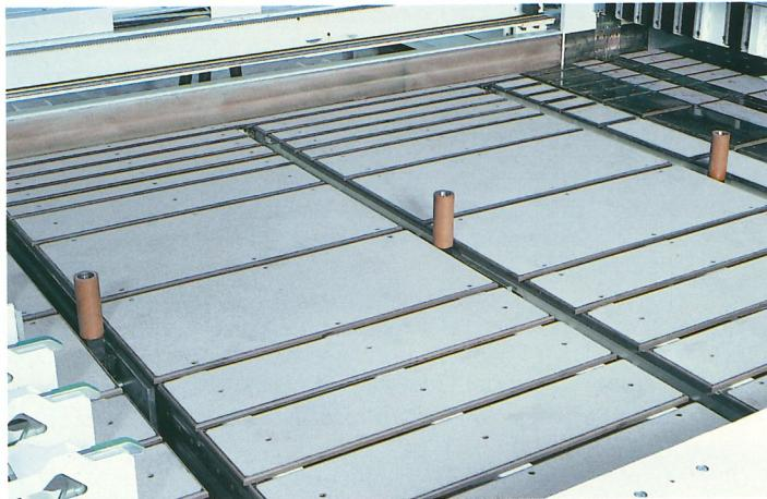
**Allineatori laterali** con corsa ottimizzata su guide prismatiche a ricircolo di sfere.
