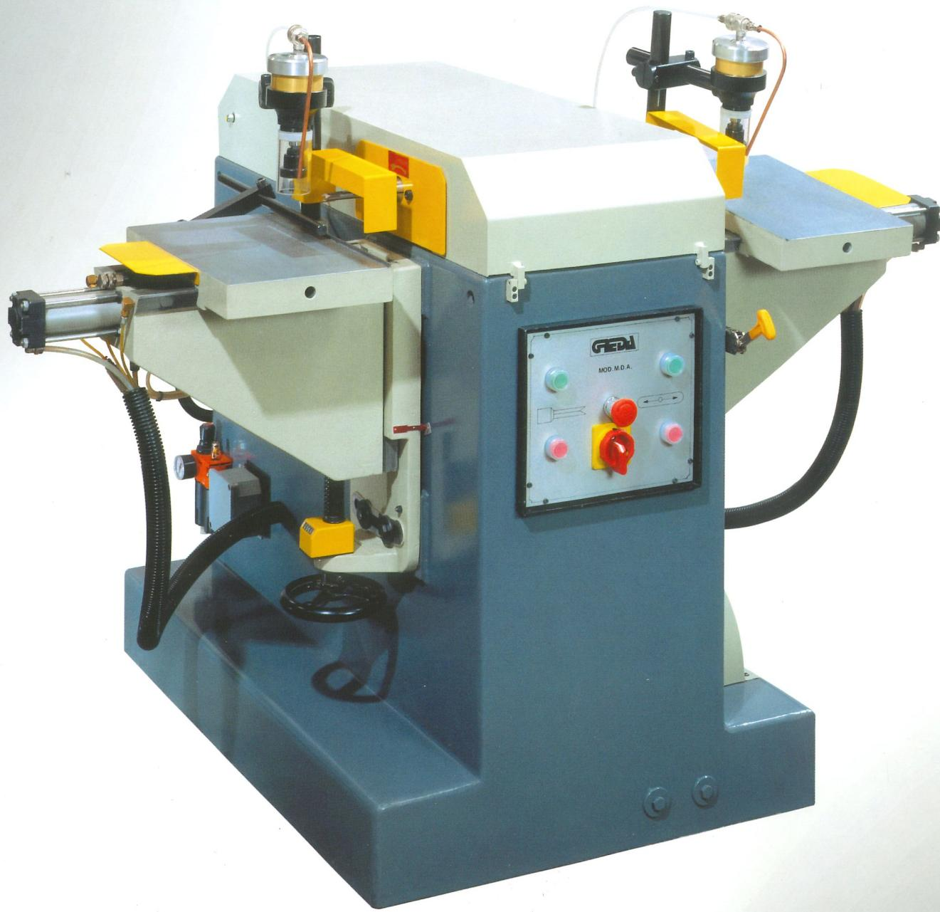
La machine travaille en combinant l'oscillation des porte-outils avec l'avance des tables.
