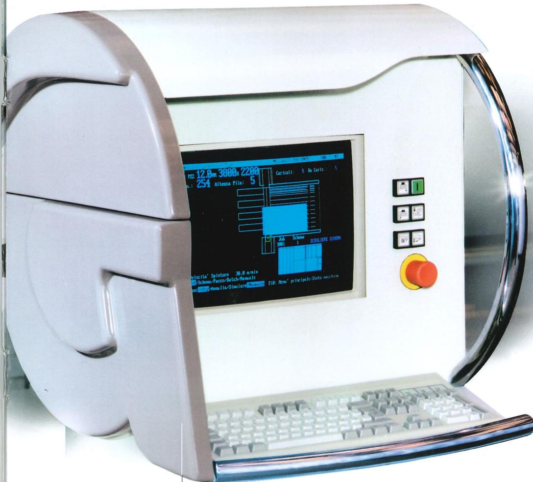
Optimale Zugänglichkeit und Ergonomie der Bedieneinheit. Die Bedienelemente und die Tastatur sind in einem 180-Grad-drehbaren Schwenkpult an der Winkelschlagseite eingebaut.
