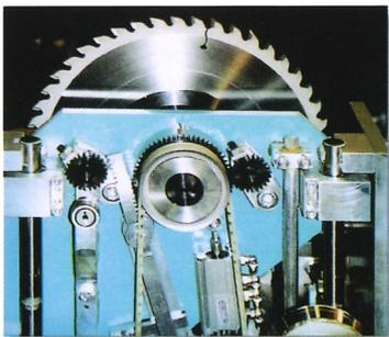
Elektronische Vorritzeinstellung für die Höhen- und seitliche Einstellung bei laufendem Werkzeug, mit visueller digitaler Anzeige (STARMATIC 1000).
