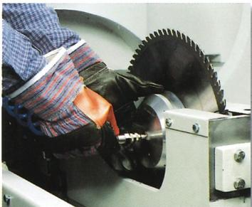
Schnellspannsystem für den Werkzeugwechsel (STARMATIC 850).
