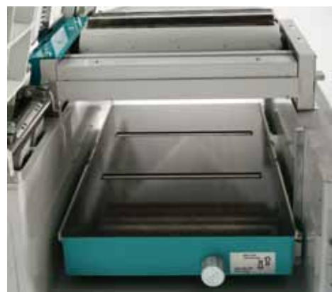
Option No. 2 rollers on the table Nr 2 Rollen in Tisch 2 ролика на столе
