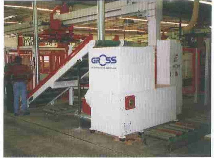
GAZ 82 mit kundenspezifischem Trichter (schallisoliert, doppelwandig)
