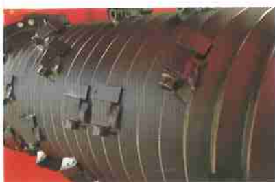
Profilorotor mit 368 mm Durchmesser und konkaven Messern
