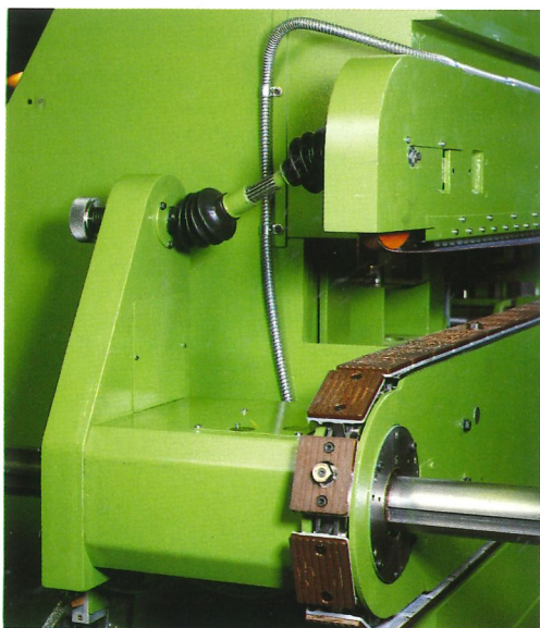
Photo d'une chaine d'entrainement à plaques.
