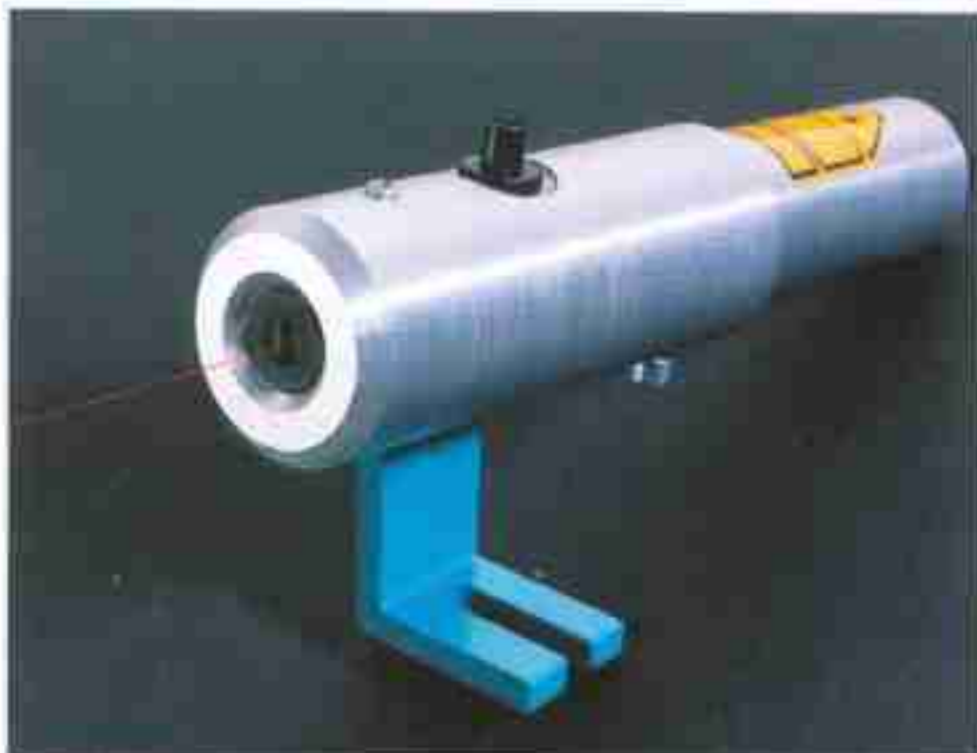
Laser-Maßanriß für Eckverbindungen
