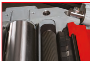
spiralverzahnte Einzugswalze spiral-toothed infeed roller
