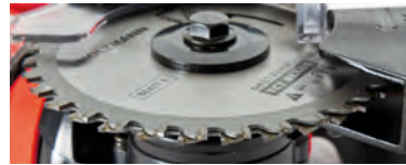
zwei sich entgegengesetzt drehende Sägeblätter two counter-rotating blades
