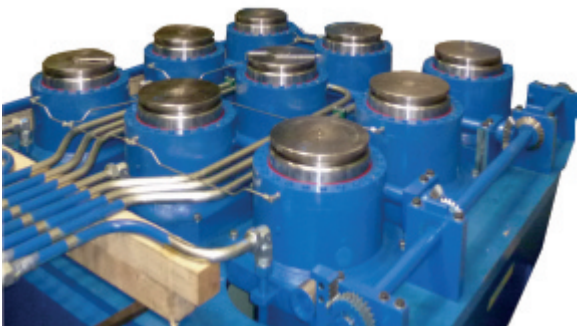
Presse mit Einzelzylinderansteuerung Press with single cylinder control
