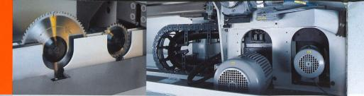
Schnell und einfach können das Vorritz- und das Hauptsägeblatt gewechselt werden. Mit der Funktion »Eichen Sägeblatt« lässt sich die Schnittvermaßung auf 1/100 genau von der Steuerung aus justieren. Bei einem Servicebedarf kann das Sägeaggregat aus dem Maschinenständer ausgefahren werden.
