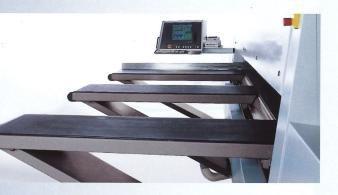
Der frei programmierbare, präzise geführte Seitenanschlag drückt mit seiner runden Gummiwalze das Werkstück beständig gegen den Anschlag und erzeugt so einen winkligen Schnitt bei langen Werkstücken.
