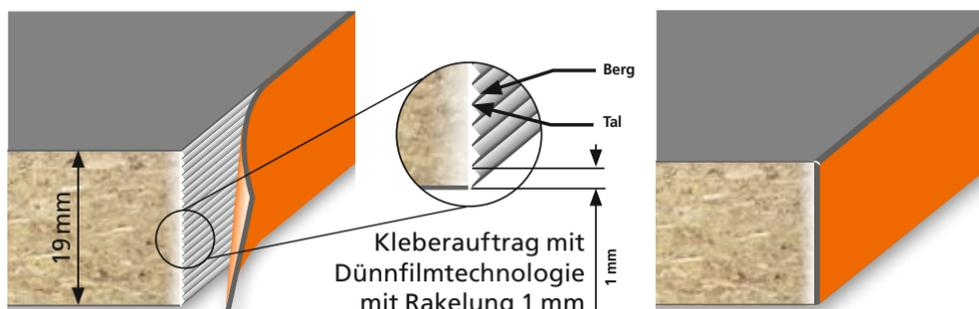
Mit der neuen Glu Jet Dünnschichttechnologie dringt der Kleber tief in die Plattenstruktur ein.
