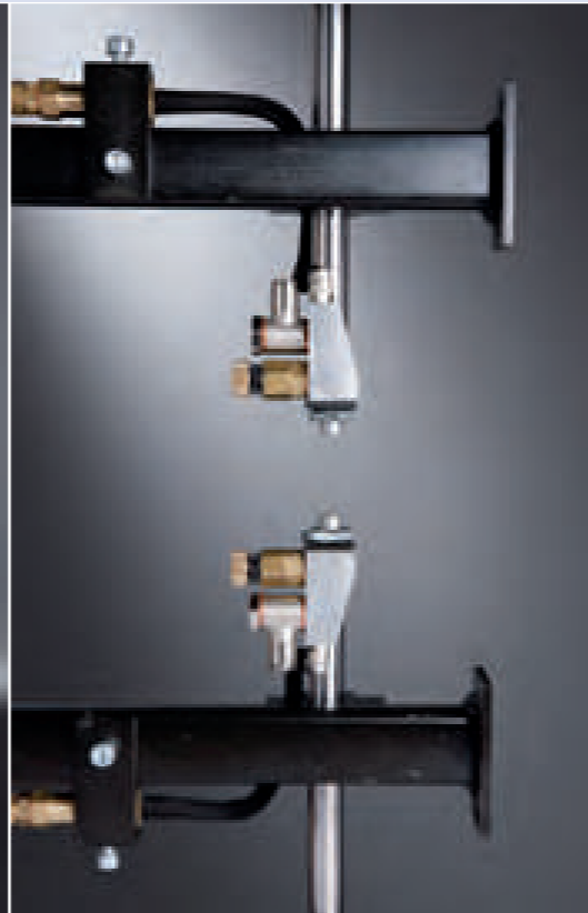
Application d'agent nettoyant Dispositif de pulvérisation pour l'application d'agent nettoyant sur la partie supérieure et inférieure de la pièce. Montage en amont de l'agrégat de polissage.
