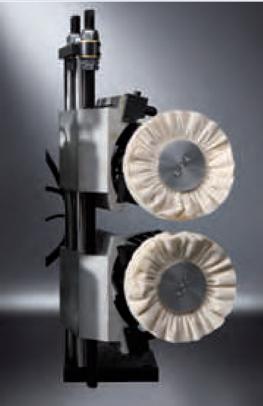
Agrégat de lustrage FA06 supérieur et inférieur Pour des chants impeccables.
