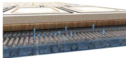
*Fonction coussin d'air pour une manipulation aisée des pièces de grand format*
