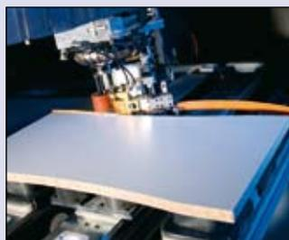
Une interface électronique brevetée permet l'utilisation des agrégats d'encollage interchangeables EasyEdge et PowerEdge pour un encollage de chants optimal sur des pièces de forme. Une finition de qualité élevée grâce à différents agrégats.
