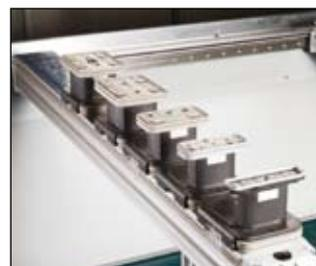
La table à consoles équipée de ventouses brevetées permet une fixation fiable de diverses pièces
