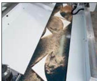
Bâti de machine rigide avec dispositif d'évacuation de chutes intégré sur l'ensemble de la zone d'usinage. Les restes ne tombent pas devant la machine (en option avec tapis de transport pour copeaux)
