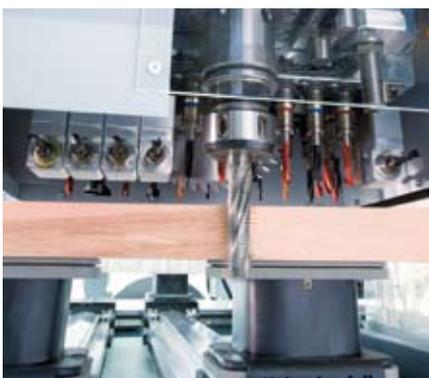
Multi Processing Unit – une technique de perçage à dimension nouvelle. L'ensemble de l'unité peut pivoter en continu de 360°.
