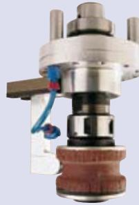
Fixation pour disque de ponçage avec buse soufflante intégrée pour un nettoyage continu
