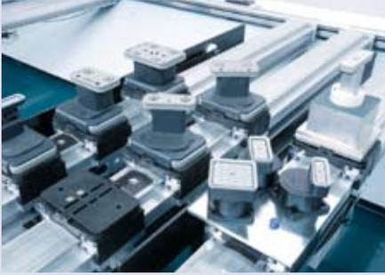
Divers éléments de serrage pneumatique et ventouses garantissent un usinage précis de divers matériaux et pièces
