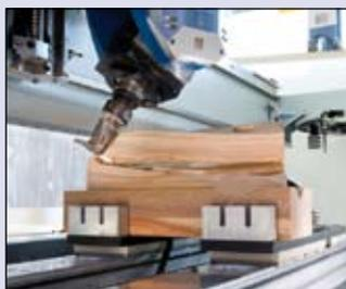
La construction rigide de la console est prévue pour la broche de fraisage à 5 axes DRIVE5+ avec une hauteur de pièce maximale de 300 mm – pour les longueurs d'outils de 230 mm (avec fixation HSK)
