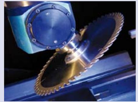
Agrégat FLEX5 – réglage automatique de l'angle de rotation pour le rainurage continu
