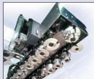
Réglage rapide grâce à une réduction des temps de changements – 8 sec. env. pour les changeurs d'outils à chaîne à 30 ou 72 positions
