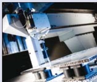
L'extrusion de chants permet de nouvelles possibilités de design sans jointure et augmente la charge admissible, pour les panneaux alvéolaires en aluminium pour l'industrie automobile, par ex.
