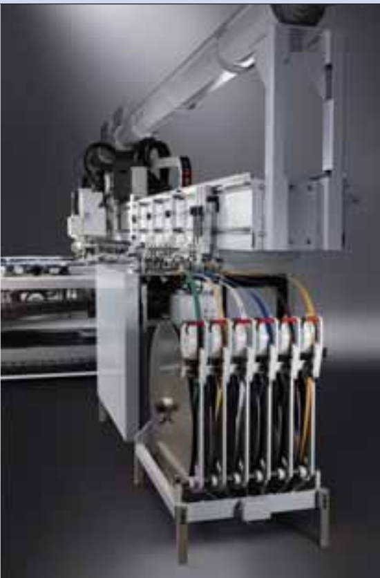
Magasin de chant embarqué en X avec jusqu'à 6 rouleaux ou externe avec jusqu'à 24 rouleaux
