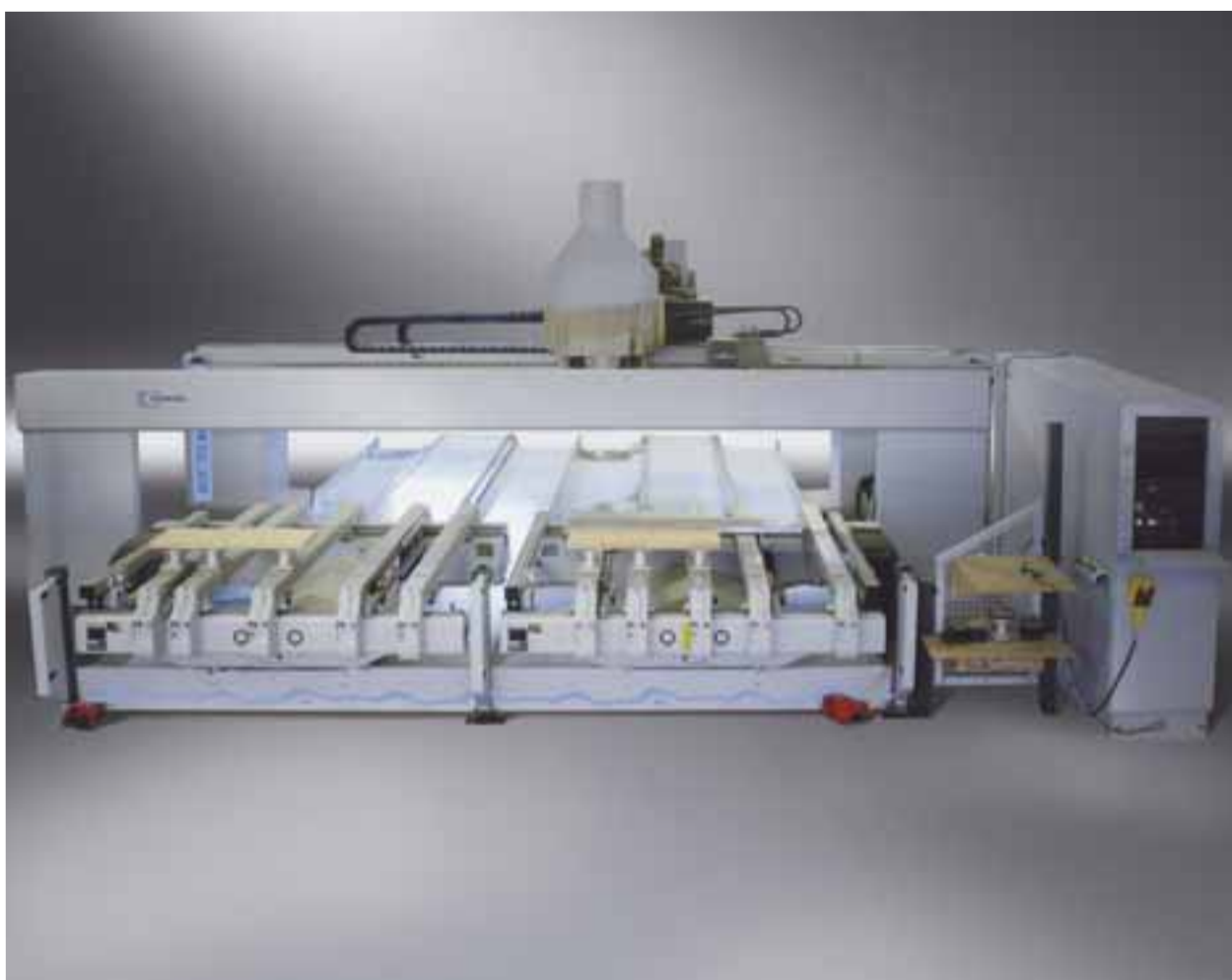
Centres d'usinage équipés de broche 5 axes et 4 axes pour l'usinage simultané de limons de mains courantes et de marches d'escaliers
