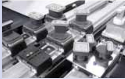
Divers éléments de serrage pneumatique et ventouses garantissent un usinage précis de divers matériaux et pièces
