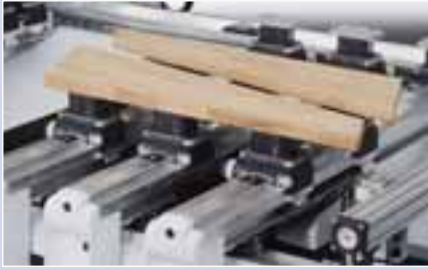
Découpe et séparation automatiques de marches d'escaliers pour un usinage circulaire complet
