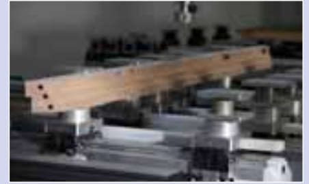
Déplacement des éléments de serrage pneumatiques après le profilage longitudinal de pièces brutes de fenêtres en Y pour un usinage sur les 5 côtés
