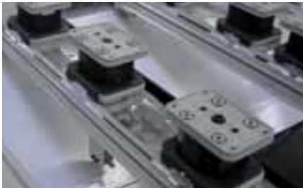
Système de positionnement LED – le système le plus rapide et le plus fiable pour le positionnement manuel des ventouses et des consoles
