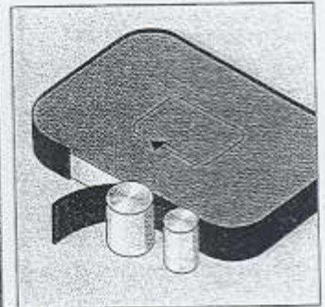
Bei der 360-Grad-Verleimung können Werkstücke mit PVC- oder Furnierkanten 360 Grad rundum verleimt werden. Das Anfangs- und Endstück der Kante wird dabei so exakt gestoßen, daß nur eine feine Haarfuge sichtbar bleibt.
