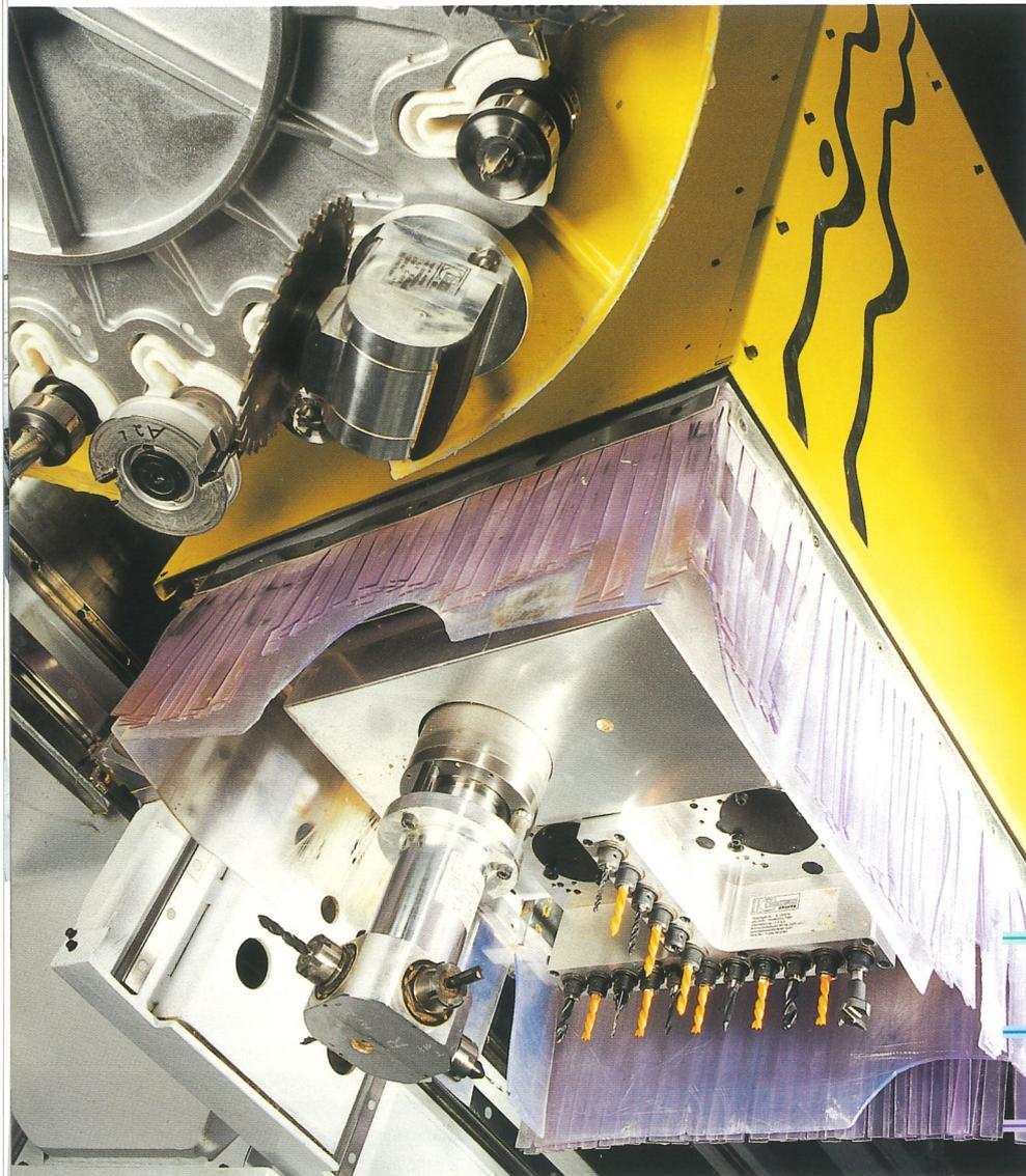
Die Bearbeitungszentren BAZ 120 und BAZ 220 arbeiten mit separaten Bearbeitungssupporten jeweils mit Hauptspindel, Bohraggregat und Adapteraggregat. Die Schnittstelle der Hauptspindel wird aus einem 18fach-Tellerwechsler und optional aus einem Aggregate-Pickup-System versorgt.
