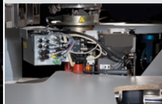
Incollaggio dei bordi a 360° con il gruppo di incollaggio powerEdge
