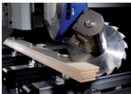
Tagli inclinati perfetti - precisi anche con grandi sezioni.
