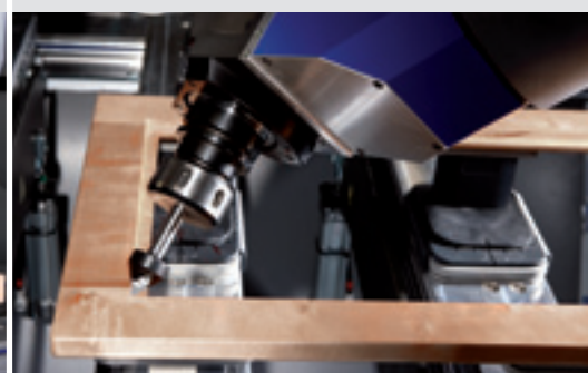
Fresata ad angolo retto su uno spigolo per la battuta del vetro
