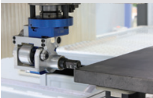
Refinitura con tastatura delle sporgenze dei bordi sul profilo postforming
