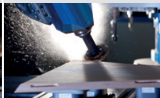
Fresatura di scanalature inclinate per giunzioni di pannelli
