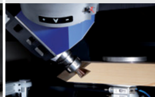
Fresagem de articulação para encaixe de construções vertical e transversal
