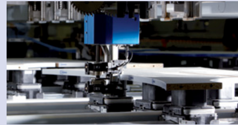
Acabamento perfeito dos bordos através do opcional combi embutido que combina refilador e raspador de bordos – racionalmente, sem troca de ferramenta.
