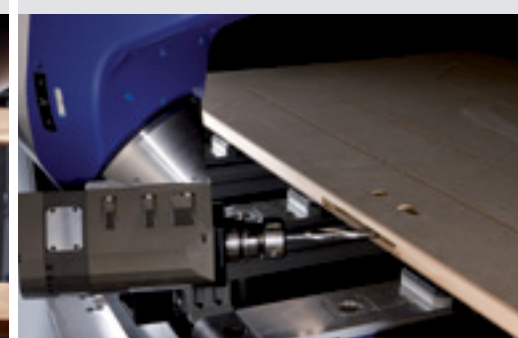
Fresagem para encaixe de fechaduras
