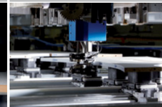
Perfeito acabamento final de cantos através do combo apalpador dos grupos refilador/raspador
