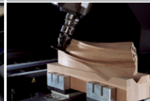
Usinagem de corrimãos de escadas
