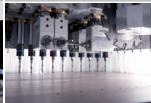
Técnica de furação em alta velocidade com serra de ranhuras
