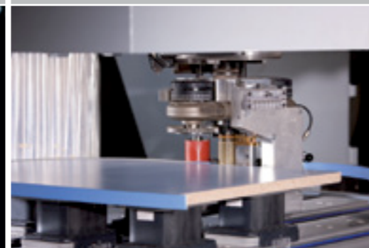
Pack d'encollage easyEdge pour un encollage rationnel des pièces de forme
