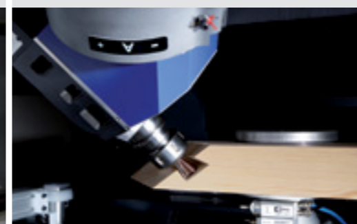
Fraisage assemblage biais pour poteaux/montants
