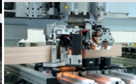
Encollage de chants pour des pièces d'une hauteur allant jusqu'à 100mm
