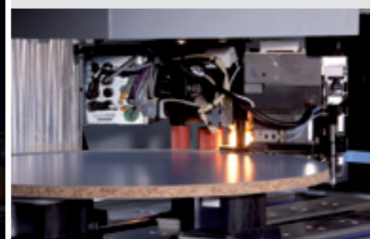
Collage du chant à 360° avec l'agrégat de placage powerEdge
