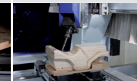
Usinage à interpolation de pièces à géométrie libre
