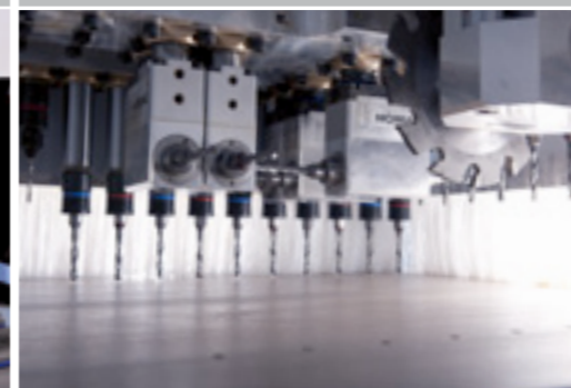
Technique de perçage High-Speed avec scie à rainurer
