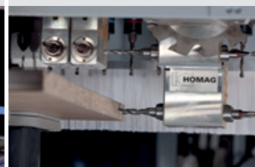
Perçages horizontaux pour assemblages de corps de meubles
