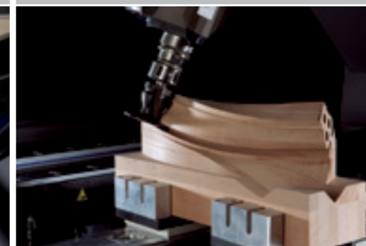
Fraisage d'une main courante d'escalier
