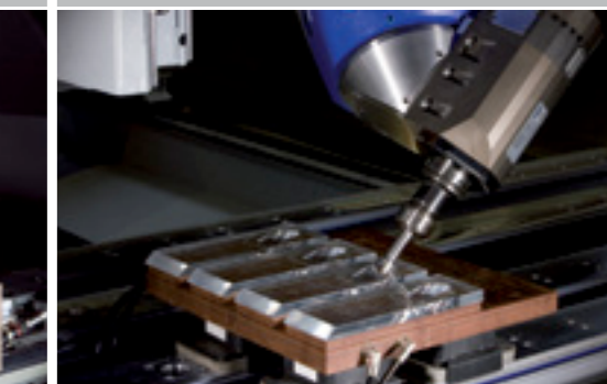
Fraisage grand brillant de pièces en acrylique
