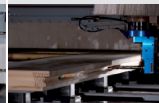
Fraisage d'un logement de serrure
