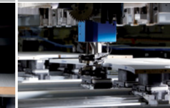
Chants d'une finition parfaite par agrégat palpé combiné ou l'affleurance et le raclage
