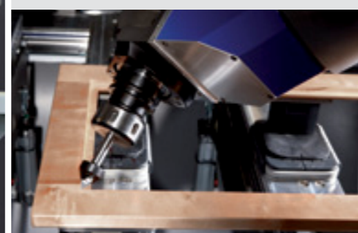
Usinage précis d'une feuillure pour l'insertion d'une vitre
