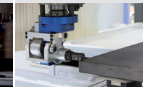
Affleurance au ras palpé des dépassements de chants de profil postformé
