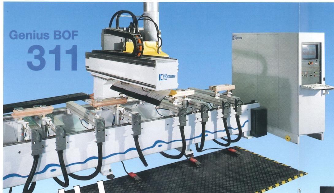
Das Spannsystem für gerade und geschweifte Fensterteile. Flächige Werkstücke können mit Vakuumsaugern gespannt werden. Die Spanner werden hierzu abgesenkt:
