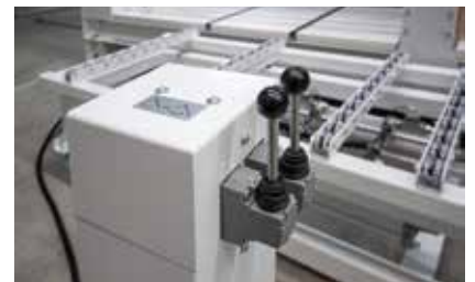
Commande de redresseur de corps : par simple action du levier, le redresseur redresse le corps de meuble pressé.
