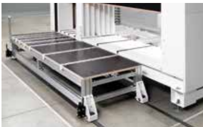
Poste de pré-assemblage déplaçable : le poste de pré-assemblage permet d'assembler facilement les corps de meubles à la hauteur de travail de la presse.
