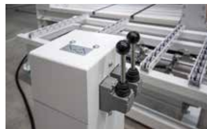
Commande de redresseur de corps : par simple action du levier, le redresseur redresse le corps de meuble pressé.
