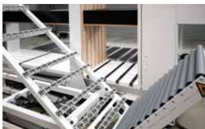
Redresseur de corps manuel : le redresseur de corps est utilisé pour le redressement et le transport des corps de meubles assemblés.
