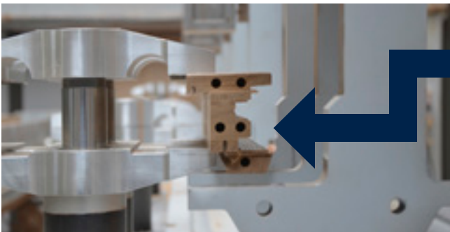
Maksymalna elastyczność dzięki swobodnemu mocowaniu we wszystkich kierunkach. Z możliwością mocowania w falcu do najwęższych obramowań
