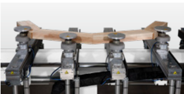
Obróbka łuków pełnych oraz obróbka powierzchniowa na stole konsolowym lub automacie (opcja)
