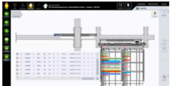
System programowania woodWOP do pojedynczych części, idealnie pasuje do parametrycznego programowania ręcznego części specjalnych oraz jako interfejs bez dodatkowego oprogramowania innych dostawców.
