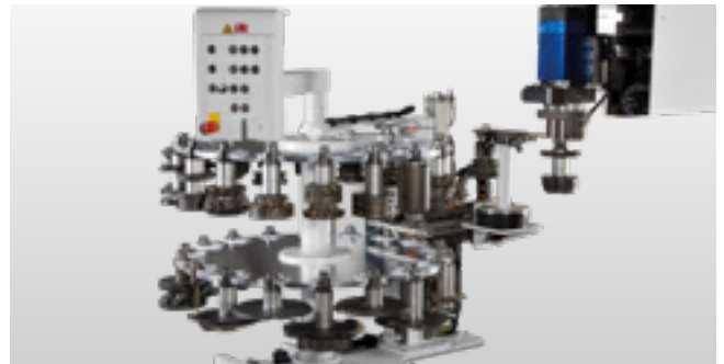
Elastyczny system zmiany narzędzia. Bezpośredni dostęp do wszystkich narzędzi bez przezbierania i zmiany sortowania, z krótkimi czasami zmiany z systemem wstępnej zmiany za pomocą uchwytu
