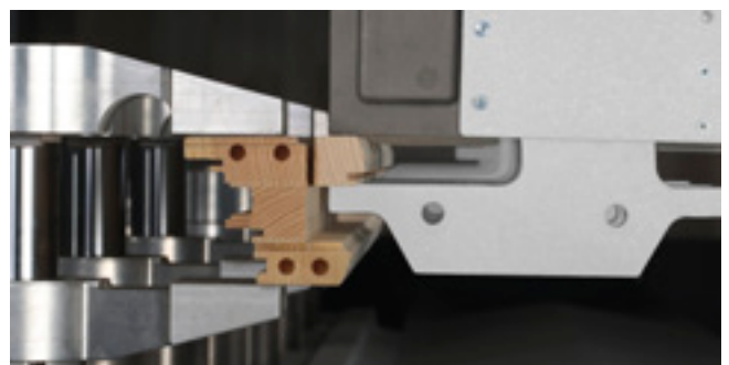
Pobieranie i separowanie listew mocujących szybę z możliwością wykańczającego frezowania w falcu szklanym (opcja)
