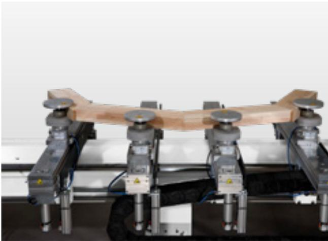
**Elementos en arco:** el mecanizado completo de arcos con un calibre de hasta 1300 mm en una pieza reduce los tiempos de fabricación y el trabajo manual (no es necesario enlucir las juntas). Naturalmente, tapajuntas adecuado incluido.
