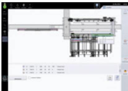
**woodFlex:** control de la línea de producción para una ejecución efectiva de listas de producción con visualización y seguimiento gráfico de las piezas en la pantalla de la máquina. En todo momento sabrá qué pieza se encuentra en qué lugar de la máquina. woodFlex permite la integración de líneas de producción con máquinas pre y posconectadas (p. ej. cepillo de 4 lados, tronzadora, etc.)
