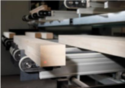
**Control de dimensiones de piezas en bruto:** en el mismo momento de colocar y sujetar la pieza en bruto, el sistema comprueba si es posible su mecanizado, lo que evita colocar piezas en bruto por error.
