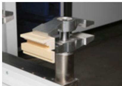
**Integración de piezas cortas:** la tecnología de sujeción y fijación también permite fabricar piezas cortas con una longitud mín. de 120 mm de antepecho.
