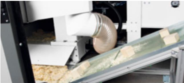
**Transportadores elevadores para residuos:** las piezas residuales del canal colector situado debajo de la máquina se pueden transportar mediante el transportador elevador directamente a un contenedor o un vehículo.
