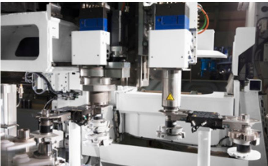
**Cambio de herramientas simultáneo:** cada uno de los dos husillos está asignado a un cambiador de herramientas de 36 o 72 puestos con sistema de cambio previo. De esta manera, pueden cambiarse herramientas en ambos husillos al mismo tiempo.
