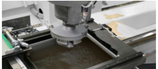
**Sistema de limpieza de herramientas:** las herramientas se limpian por la noche. Un dispositivo de limpieza mediante ultrasonido integrado en la máquina limpia las herramientas sin intervención manual. Esto facilita el cambio de las plaquitas de corte y garantiza vidas útiles prolongadas con una gran calidad superficial.
