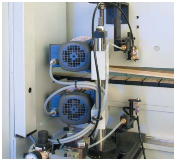
Schwabbelaggregat oben und unten mit Oszillation Zum Griffigmachen der Kanten mit Ausnutzung der gesamten Scheibenbreite.
