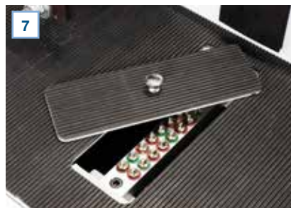
Zugängliche Zentralschmierung an der Maschinenvorderseite
