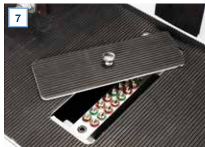
Zugängliche Zentralschmierung an der Maschinenvorderseite
