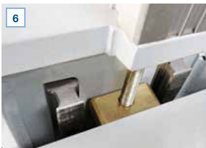
Linearführungen für eine dynamische Anpassung an den Werkzeugdurchmesser der oberen Spindel n für optimale Oberflächengüte
