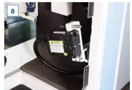
Automatische Türverriegelung bei Werkstückbearbeitung zum Schutz des Bedieners
