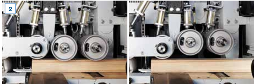
Pneumatisch verstellbare Andruckrollen für optimalen Andruck bei unterschiedlichen Profilen und Holzarten (links aktive, rechts inaktive Andruckrollen).
