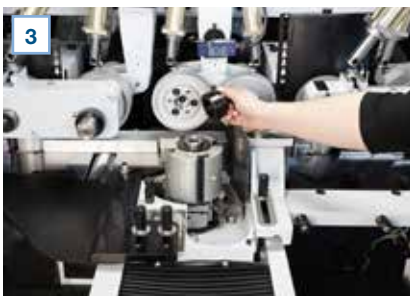
Einfacher und schneller Werkzeugwechsel mit bewährter ProLock-Spindelklemmung
