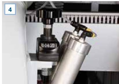
Nachverfolgung der radialen Werkzeugposition mittels mechanischer Anzeige
