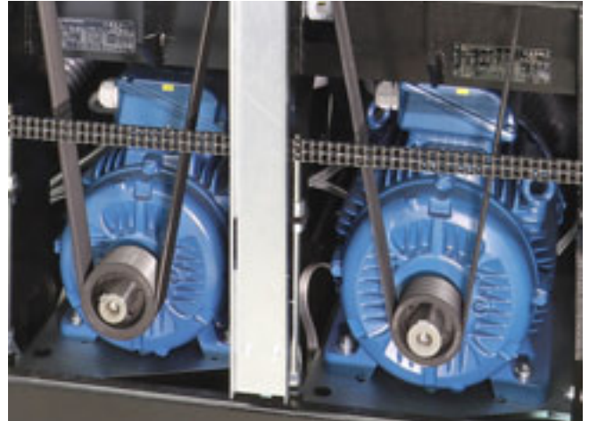
Separate Antriebsmotoren für jedes Aggregat
