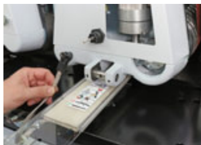
Qualität im Detail Zum Beispiel die Schleifeinsätze mit Schnellkupplung des Erdungsbandes. Sorgt für Betriebssicherheit und gute Schleifergebnisse
