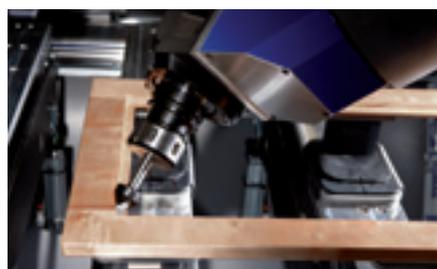
Mecanizado de un vértice de la acanaladura para el cristal de una puerta.
