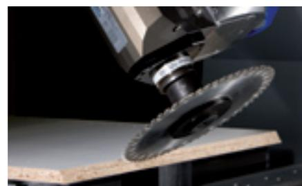
Cortes a inglete sin astillar y con precisión de ranuras oblicuas para una unión de tableros
