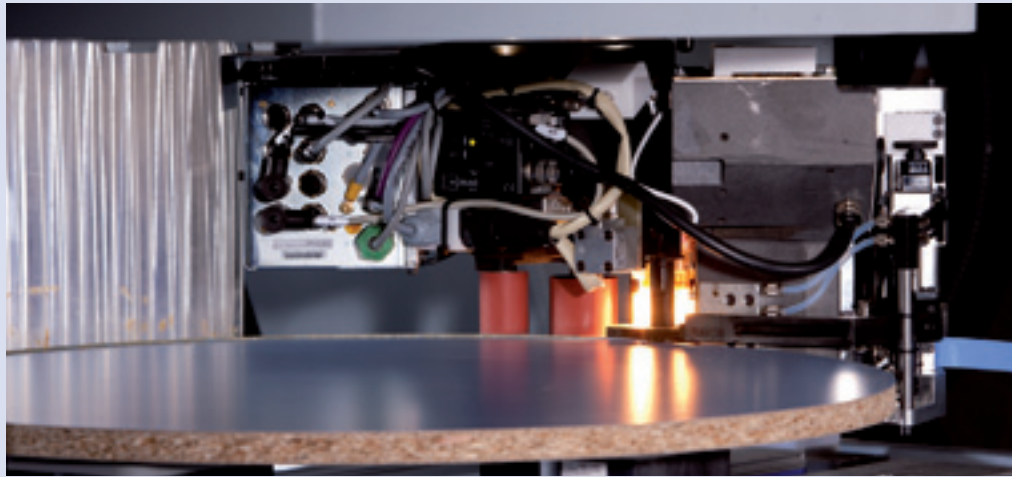
Collage du chant à 360° avec l'agrégat de placage powerEdge .
