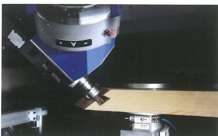
Fräsen einer Gratverbindung für Pfosten-/Riegelkonstruktionen
