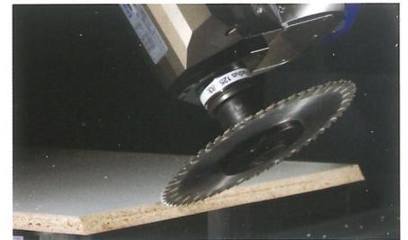
Ausrissfreie und präzise Gehrungsschnitte und Fräsen schräger Nuten für eine Plattenverbindung
