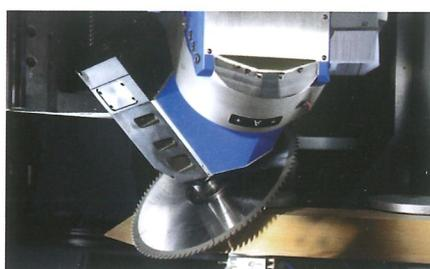
Schifterschnitt mit großer Schnitttiefe für Rahmenteile
