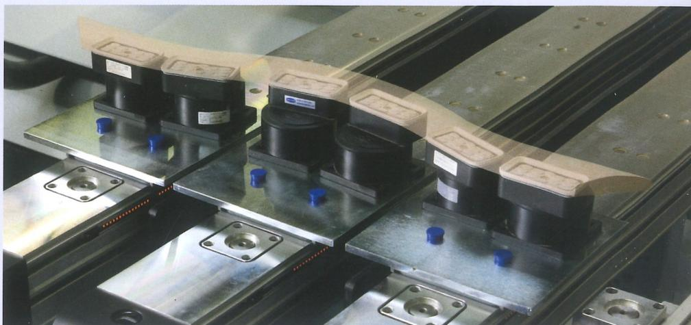
Mit einer umfangreichen Auswahl an Spannelementen können Werkstücke schnell, exakt und flexibel gespannt werden, ohne dass Sondervorrichtungen erforderlich sind.
