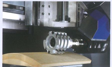
Profilieren von Formteilen mit Standard-Fräswerkzeugen
