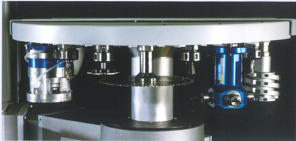
Werkzeugwechsler bieten die Grundlage für den flexiblen Einsatz von Werkzeugen und Aggregaten, auch mit großen Durchmessern von bis zu 200 mm. Sägeblätter können sogar einen Durchmesser von 350 mm aufweisen für große Schnitttiefen.
