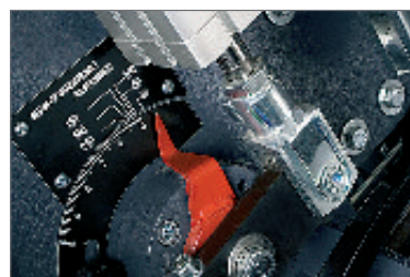
MECHANICKÁ KOREKCE PRACOVNÍ VÝŠKY V ZÁVISLOSTI NA ZRNITOSTI PÁSU
