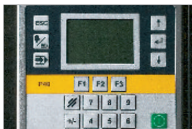
ELEKTRONICKÉ ODMĚŘOVÁNÍ VÝŠKY STOLU S DIGITÁLNÍM UKAZATELEM A NAJETÍM DO POLOHY
