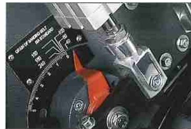
MECHANISCHE KORREKTUR DER ARBEITSHÖHE IN ABHÄNGIGKEIT VON DER SCHLEIFBANDKÖRNUNG
