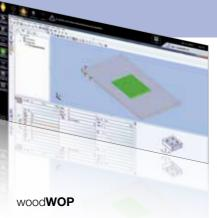
woodWOP ist die bewährte Software der HOMAG Group, mit der Sie sämtliche CNC-Programmierungen durchführen können. Bei der Säge HPP 300 multiTec wird woodWOP eingesetzt für das Bohren, für Hinterschnittbohrungen sowie für das Fräsen von Ausschnitten oder Taschen.
