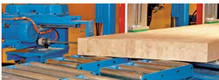
Perceuse inclinable à 360° sur une profondeur allant jusqu'à 1250 mm
