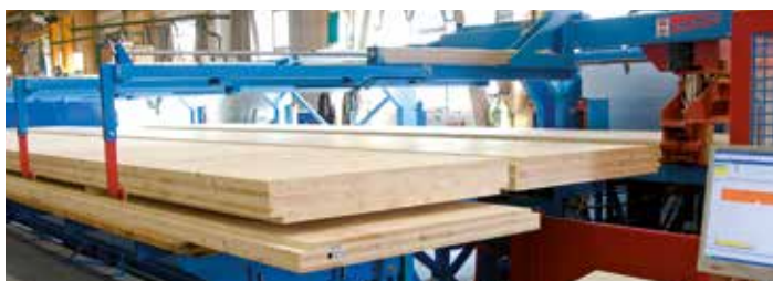
Dépilleur automatique, également adapté aux panneaux lamellés collés
