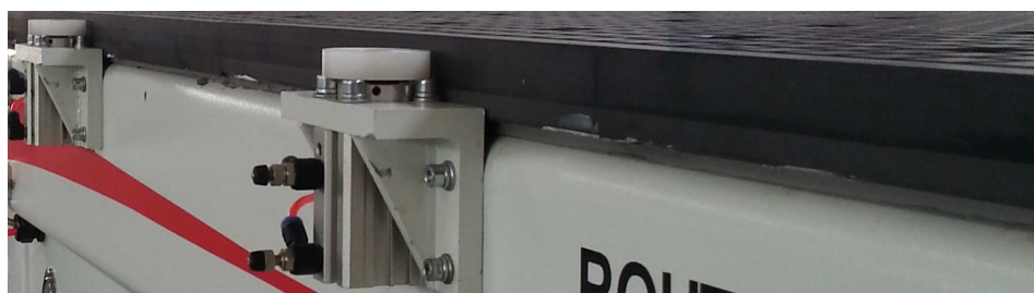
Bild 10. Pneumatische Anschlüsse für X und Y Achse
